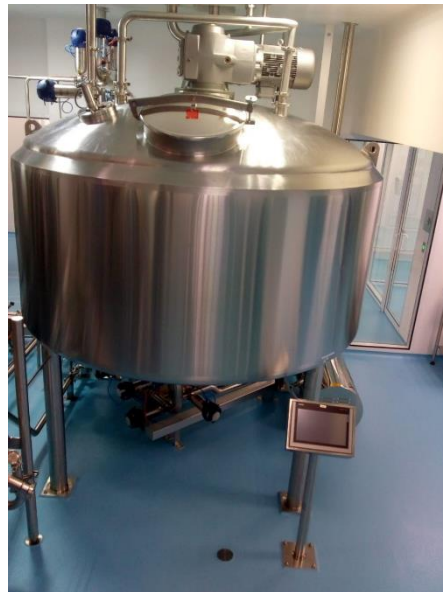
Reactor de Fabricación de Líquido
