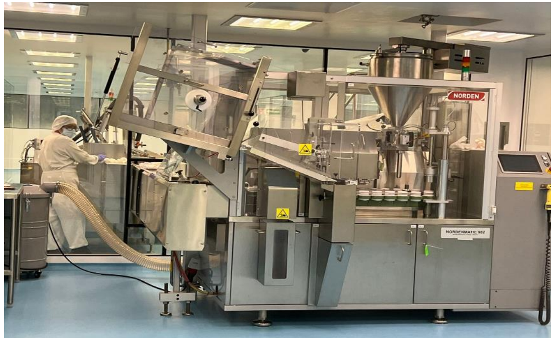
Línea de Manufactura de Productos Semi-sólidos (OTC)
