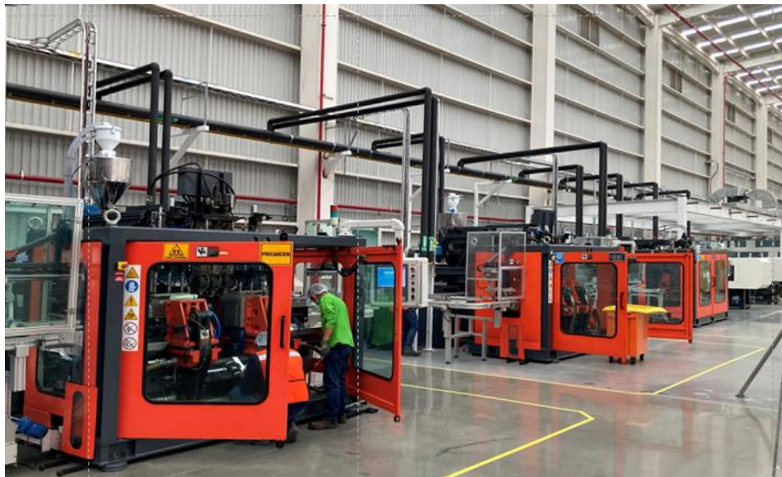
Tres líneas de moldeo por extrusión-soplado (Planta de Cuidado Personal)
