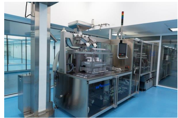
Uhlmann BEC 700 Línea de armado y empaque para la Producción de blisters
