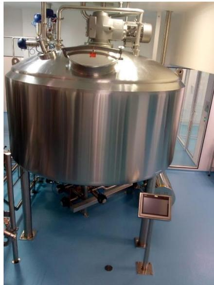
Reactor de Fabricación de Líquido
