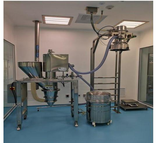
Tamizador y Sistema de Vacío (**Línea de Manufactura Sólidos**)
